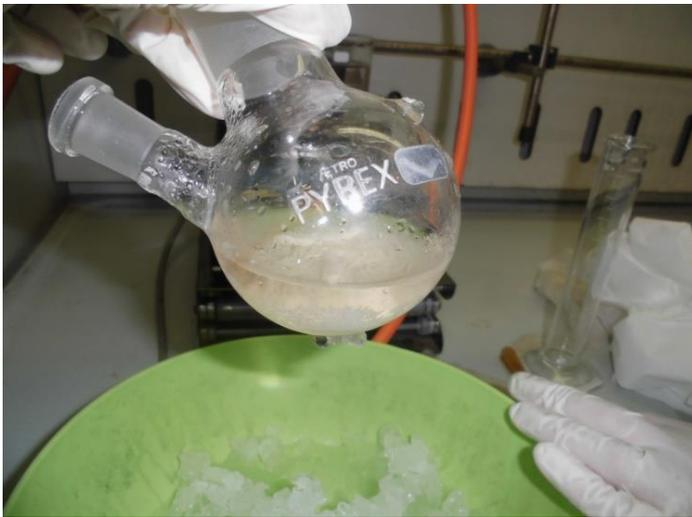
▶ **La soluzione all'interno del pallone cambierà di colore, diventando gialla chiara. Dopo pochi minuti si forma un precipitato di paracetamolo.**
