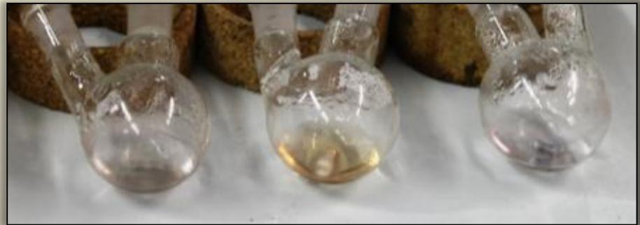
Nanoparticelle d'oro: l'intensità della colorazione varia con la concentrazione
