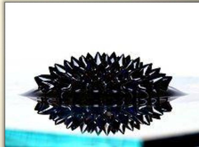
Ferrofluido collocato su una lastra di vetro, che lo separa da un magnete sottostante.
