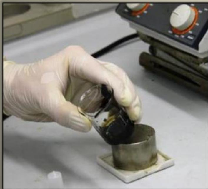
Separare il precipitato con l'aiuto di un magnete e lavare con H<sub>2</sub>O per due volte.
