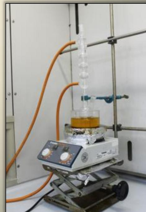
Collegare l'apparato per il riflusso (refrigerante, tubi per l'acqua) e portare ad ebollizione sotto agitazione magnetica.
