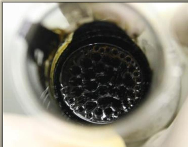
Un ferrofluido è formato da una matrice solida (NP di ossidi di ferro) dispersa in un solvente. Poiché tali NP rispondono ad un campo magnetico orientandosi lungo le linee di campo, e sono assimilabili ad un fluido, se si avvicina un magnete la superficie forma spontaneamente una sequenza regolare di increspature, dando luogo a strutture ben definite.
